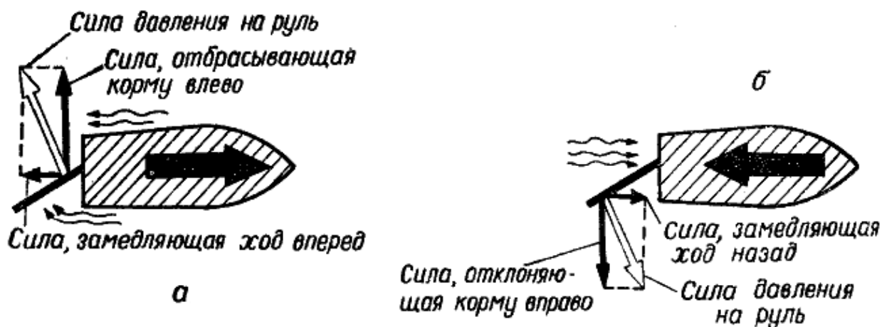
Рис. 95. Действие руля: а — на переднем ходу; б — на заднем ходу
