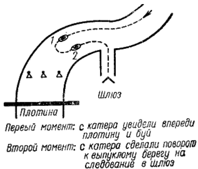
Рис. 126. Подход катера к плотине
