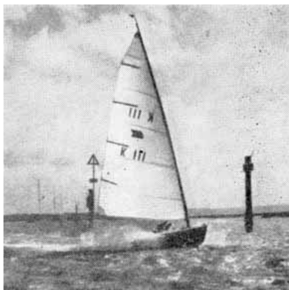
Этот швертбот "О. К." глиссирует с максимальной скоростью и с правильным креном. Рулевой сидит близко к корме яхты.
