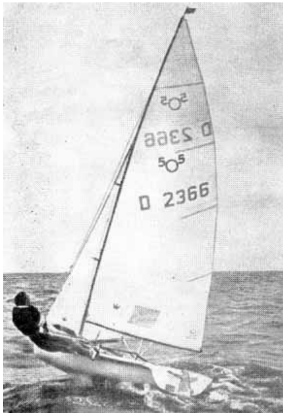
На этом фото швертбот "5-0-5" идет в лавировку. За счет небольшого крена на подветренный борт сократилась площадь смоченной поверхности.
