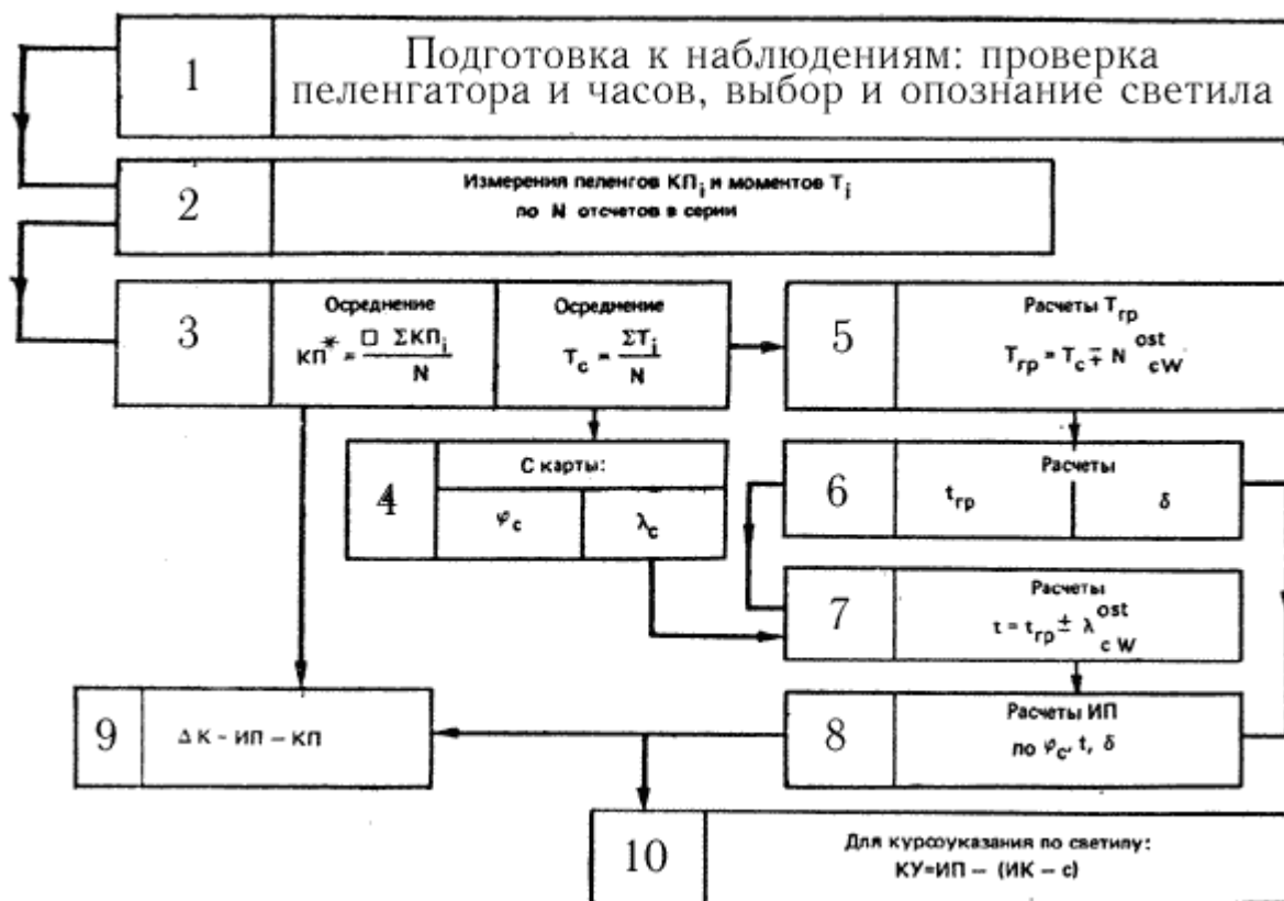
Рис. 95. Структурно-формульная схема курсоуказания по светилу и определения поправки компаса.
